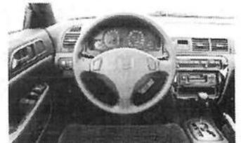
Wunsch kann der Fahrer mit dem Wählhebel die Gangwechsel manuell vornehmen, wobei ein Anzeigendisplay auf den eingelegten Gang und den angesteuerten Schaltmodus hinweist. Foto: Honda
