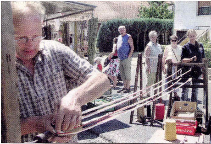
Seilerei: Hans Dieter Dören aus Altenbeken zeigte, wie man Seile aller Art von Hand produziert.
