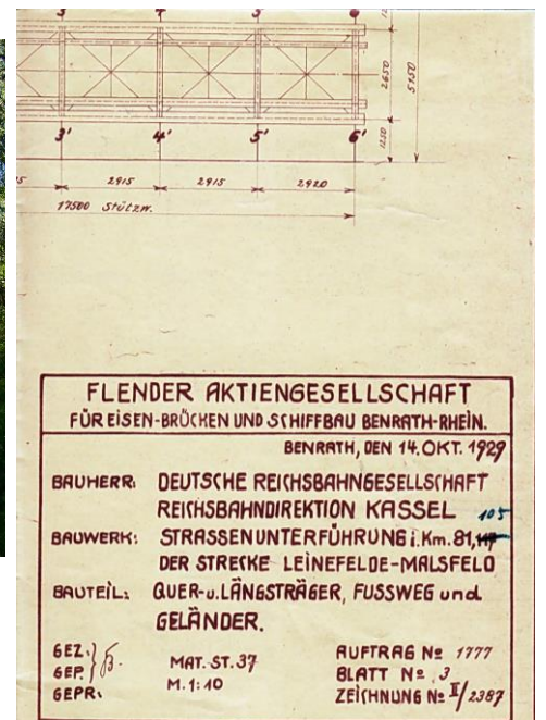
Die unterschiedlichen Längen der Längsträger und des Geländers laut Plan vom 14. 10. 1929. (Sammlung Reinhold Salzmann)
